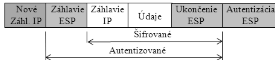
Paket IPsec ESP (tunelový režim)
